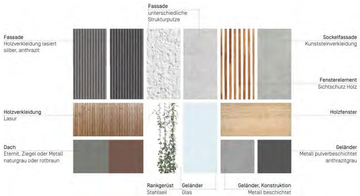
Abb. 32: Materialkonzept für Fassaden, ThalerThaler Architekten
