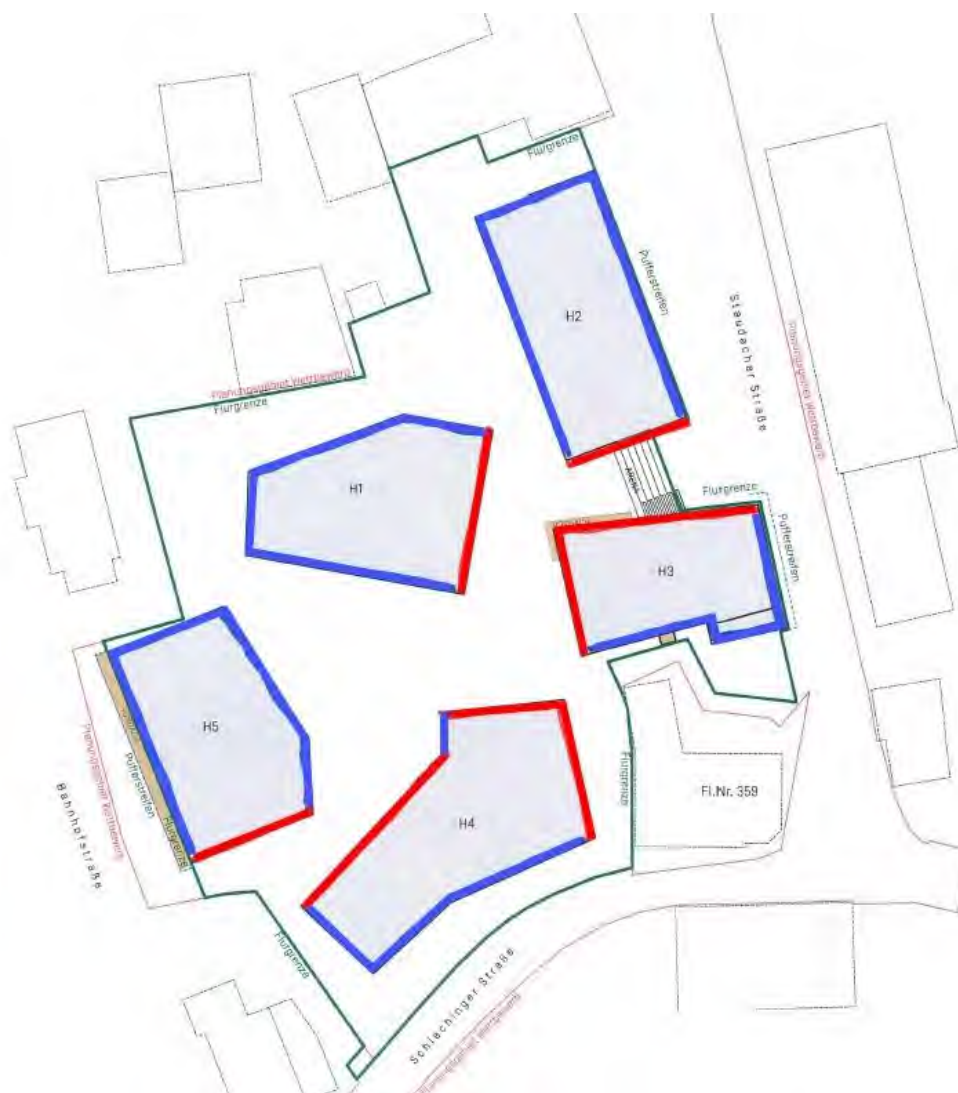
Abb. 27: Systematik der Baugrenzen: rot: hier liegen Baugrenzen direkt an der Fassade an; blau: hier bieten die Baugrenzen einen Spielraum von 30 cm zur Fassade, ThalerThaler Architekten
