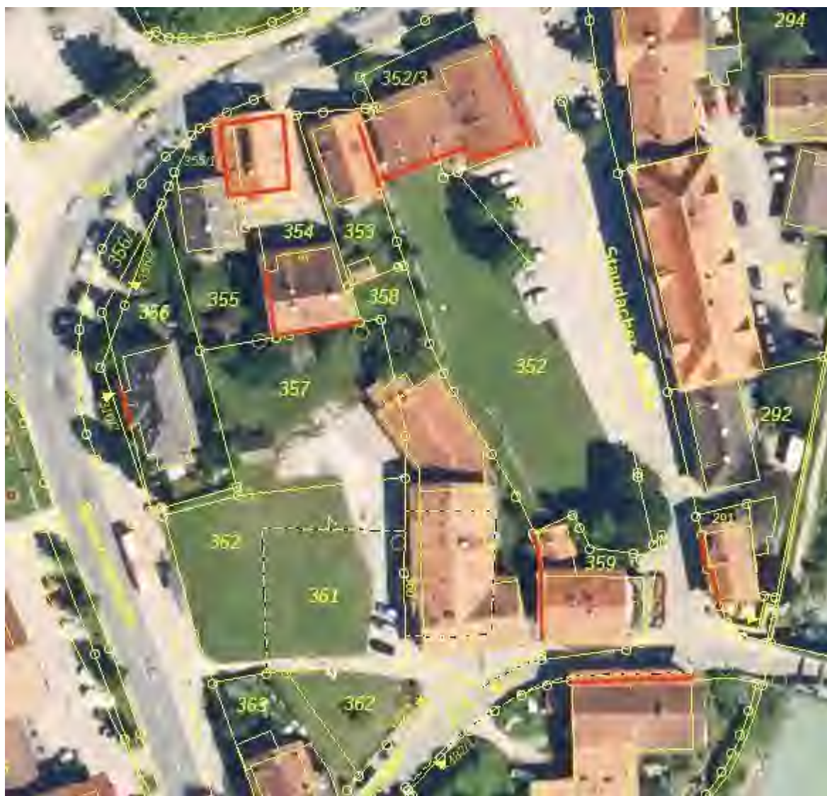
Abb. 29: Gebäudefassaden im näheren Umfeld (in Rot) mit Grenzbebauung bzw. annähernder Grenzbebauung
