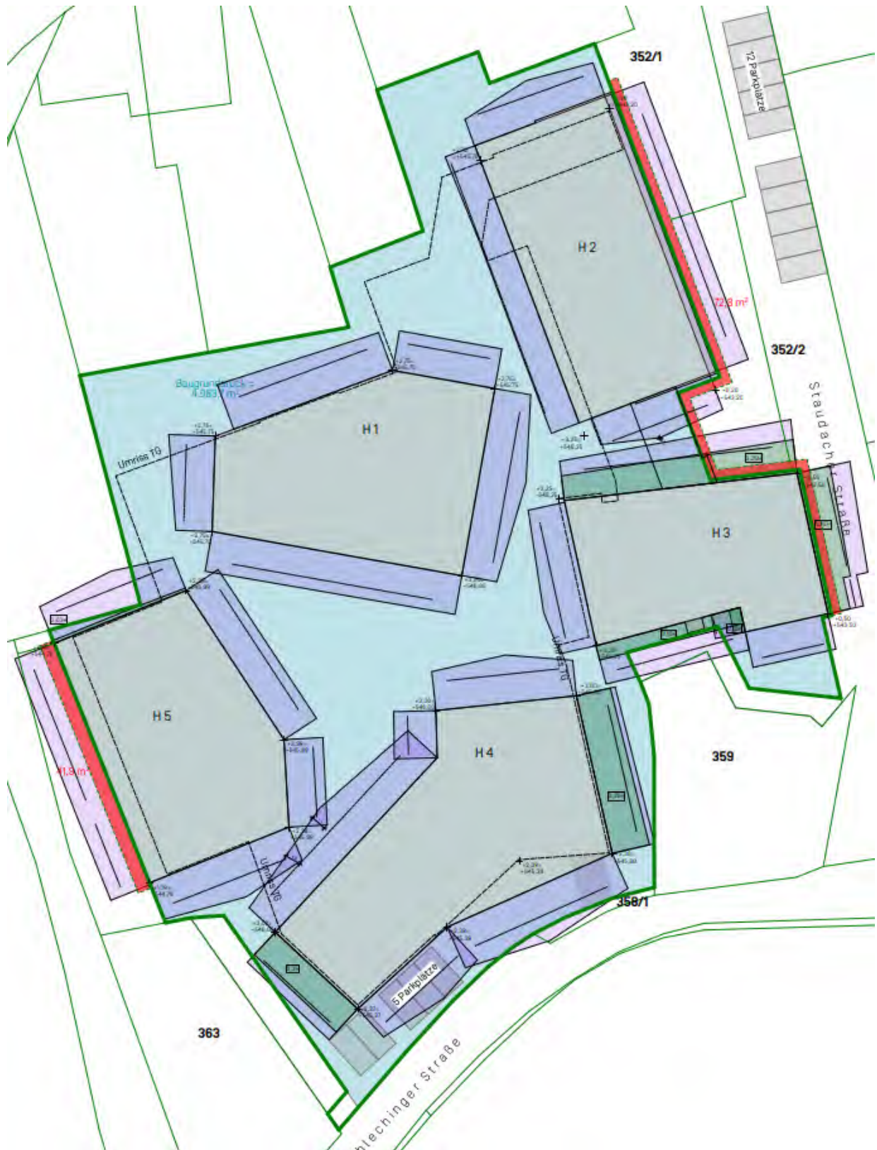
Abb. 30: Darstellung der Abstandsflächen 0,4 H nach BayBO (lila) sowie der verkürzten Abstandsflächen (grün) im Vorhabengebiet, ThalerThaler Architekten
