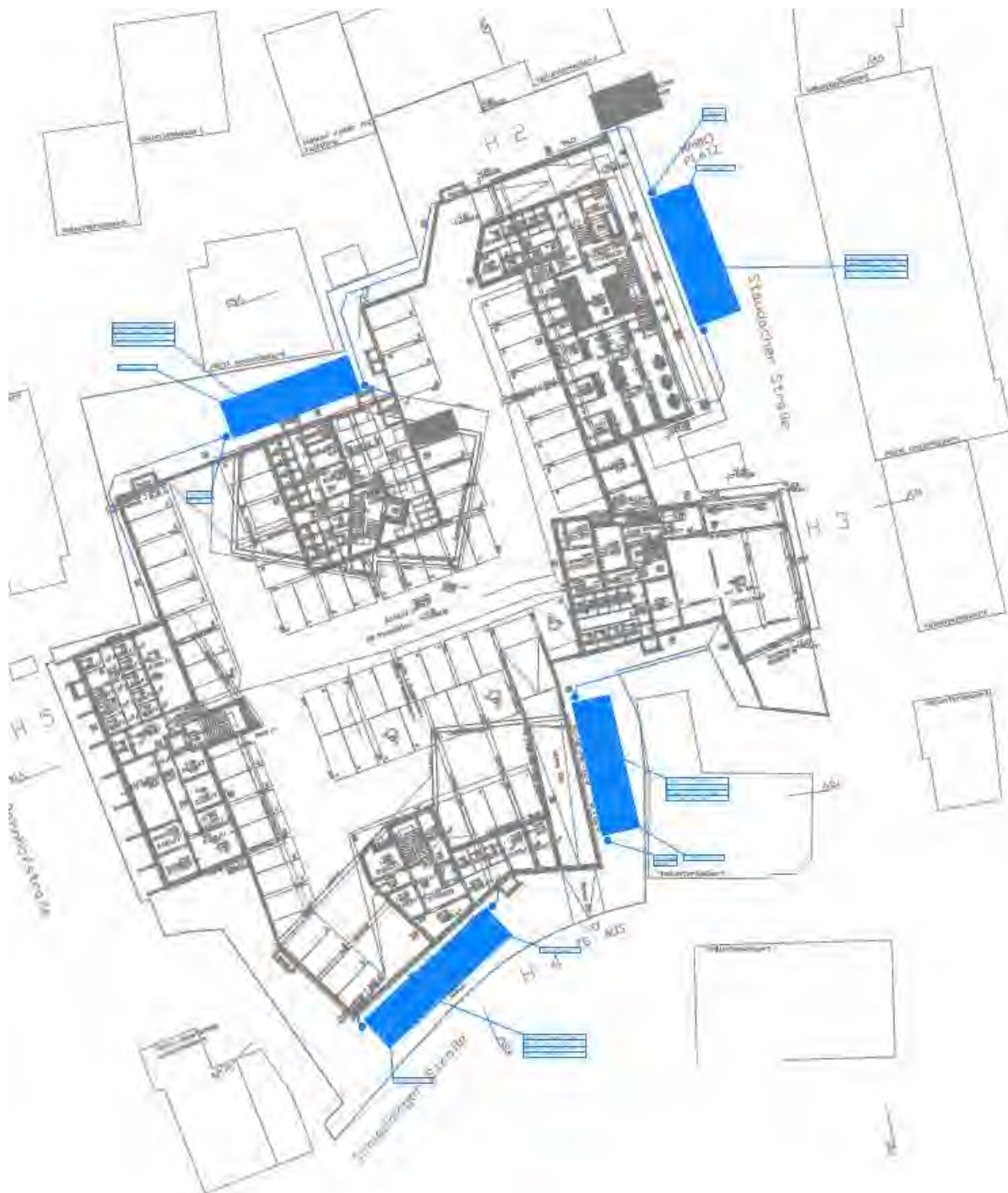
Abb. 5: Lage der Rigolen (in blau) gemäß derzeitigem Stand Entwässerungskonzept, HLS-Tec Piendl Planungsgesellschaft mbH v. 25.10.2022
