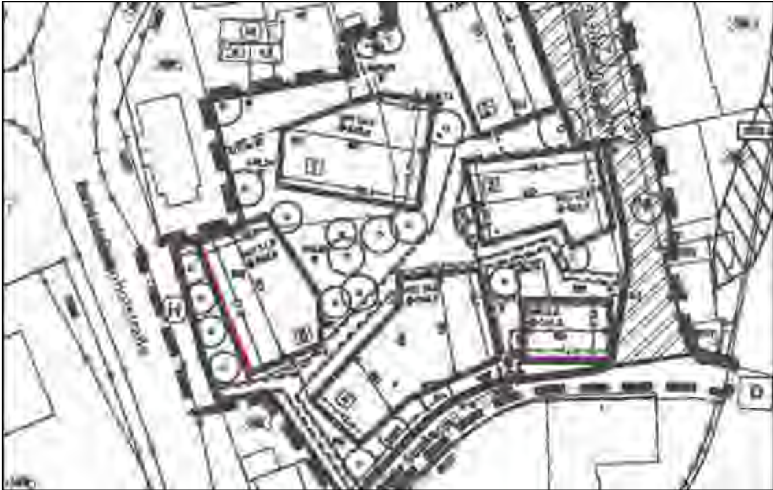
Abbildung 12: Lageplan mit Darstellung der Fassadenbereiche, an denen Festsetzungen zum Schallschutz notwendig sind
