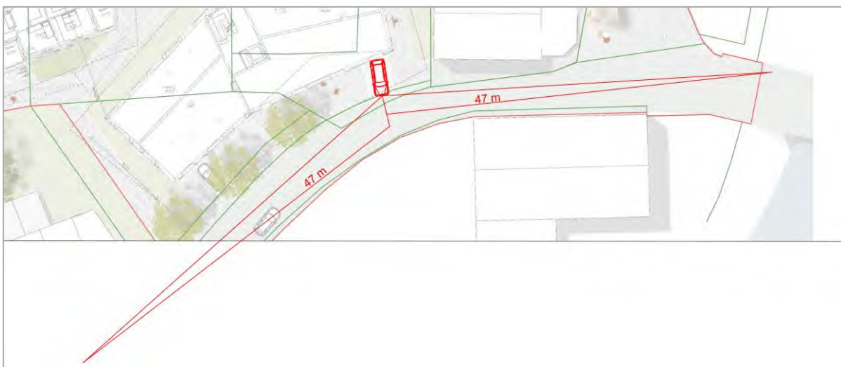
Abbildung 13: Empfohlener, freizuhaltender Sichtraum der Haltesicht gemäß der RASt 06 [Plangrundlage: THALER THALER ARCHITEKTEN / rajek barosch landschaftsarchitektur, Stand: 24.03.2022]
